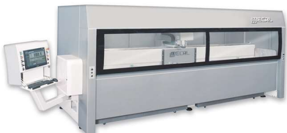
Centre d'usinage 3 ou 4 axes Bâti robuste, moteur puissant Poutre basculante 250° Magasin central 10 positions Eaux indépendants
